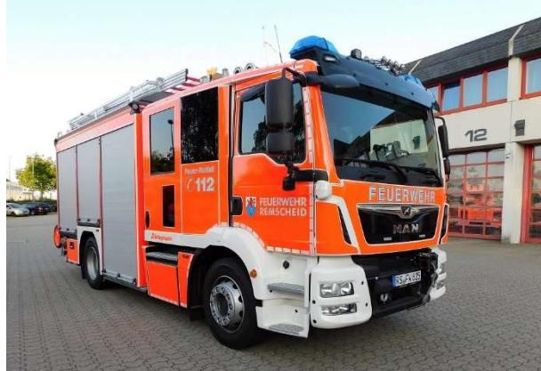
Der feuerwehrtechnische Aufbau besteht aus dem Mannschaftstraum, der an den Fahrerraum angebaut ist und dem Gerätekofferaufbau. Entsprechend der Aufgabenstellung, ein möglichst breites Spektrum an Feuerwehreinsatzlagen bewältigen zu können, ist die Ausstattung sehr umfangreich. Herausragende Leistungsmerkmale sind die eingebaute Pumpenanlage, ein Löschwassertank mit 2.200 Liter Inhalt, ein Lichtmast sowie eine maschinelle Zugeinrichtung / Seilwinde.
