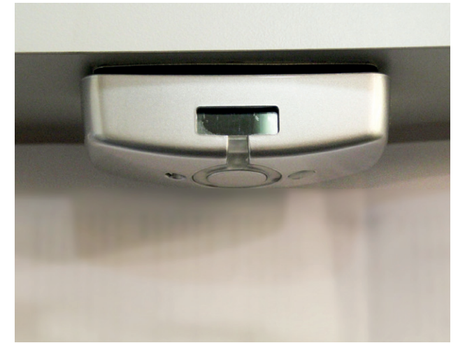
Eine Herdsicherung kann Brandfälle verhindern, da sie automatisch für die Abschaltung des Herdes sorgt.
