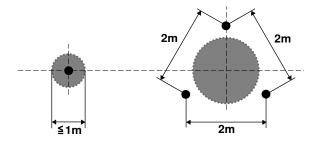
• Beim "Berliner Verbau" sind die Sondierbohrungen an den Stellen der Träger einzubringen.
