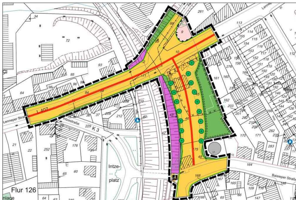
Bild 1: Streckenabschnitte mit berücksichtigter Straßendeckschichtkorrektur für Asphaltbeton AC 11
