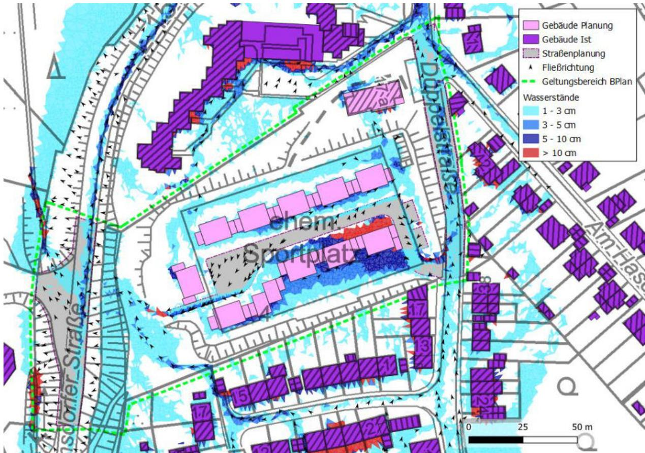
Abb. 4-1: Maximale Überflutungstiefen aus Berechnung mit integrierter Straßenplanung
